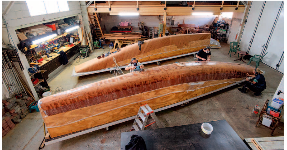
Das Boot wird in ZWEI HÄLFTEN hergestellt. Die Verklebung von linker und rechter Seite erfolgt am Kiel
