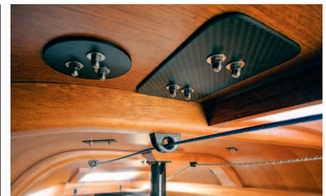
BESCHLÄGE Winschen/Klemmen sind mit Carbonplatten unterlegt. Auch die Leitösen überzeugen
