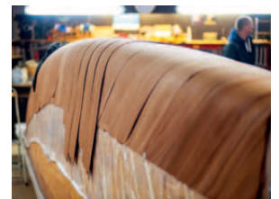
VERLEIMUNG Zwei Lagen werden 90 Grad versetzt diagonal, die letzte horizontal aufgebracht
