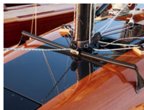
SELBSTWENDEFOCK Die Schiene für den Schot- wagen sitzt auf einem filigra- nen Träger aus Kohlefaser
