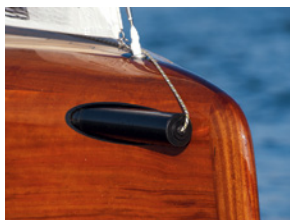
BUGSPRIET Die Öffnung für das ausfahr- bare Carbonrohr fluchtet mit den Rumpflinien
