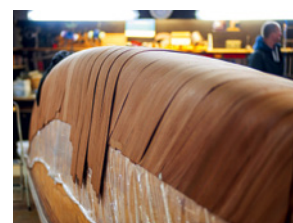
VERLEIMUNG Zwei Lagen werden 90 Grad versetzt diagonal, die letzte horizontal aufgebracht
