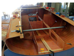
AUSBAU Nach dem Zusammenfügen des Rumpfes werden Schotten und Stringer eingesetzt
